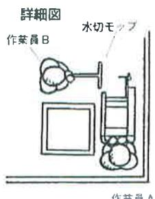
当該工事は、高架橋の耐震補強工事であり、外部への粉塵・騒音を抑制するため仮囲いの隙間をシート等で養生し作業を行っていた。仮囲い内でコンクリート舗装をエンジン式コンクリートカッターで切断中、作業員1名が気分が悪いと現場代理人に申し出てきた。同一箇所で作業していた他の作業員も同様に気分が悪いことを確認したため救急車を要請し病院へ搬送した。
